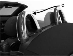
STEP 2- THE HOLES FOR DRIVER'S SIDE BRACKET SHOULD NOW BE IN THE PROPER POSITION FOR BRACKET IF DEFLECTOR IS CENTERED ON PANEL (D). USING A 1/8" ALLEN WRENCH INSTALL BRACKET (E) ON DRIVER'S SIDE. INSURE BOTH BRACKETS ARE TIGHT ON ROLL BARS. IF NEEDED YOU CAN LOOSEN PASSENGER BRACKET AND TORQUE BOTH DOWN AT ONCE. IF YOU HAVE THE NON-LIGHTED VERSION YOU ARE NOW FINISHED.
