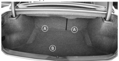
3. FINISH REMOVING ALL PLASTIC RIVETS HOLDING SIDE CARPET PANEL. THE ONES WITH ROUND OPENING REQUIRE A LOT OF FORCE TO BE PULLED OUT IT HELPS TO ROCK BACK AND FORTH WHEN YOU ARE PULLING. REMOVE BACK PLASTIC PANEL SHOWN (C)
