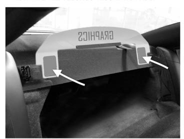
4. IF YOU PURCHASED THE POWER PACK PLUG IT IN AND MOUNT THE PACK TO SIDEWALL SO THAT IT IS HIDDEN WHEN SEATS ARE BACK. LOCK REAR SEATS BACK INTO PLACE.
