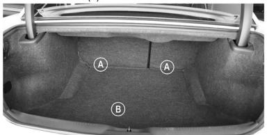
3. FINISH REMOVING ALL PLASTIC RIVETS HOLDING SIDE CARPET PANEL. THE ONES WITH ROUND OPENING REQUIRE A LOT OF FORCE TO BE PULLED OUT IT HELPS TO ROCK BACK AND FORTH WHEN YOU ARE PULLING. REMOVE BACK PLASTIC PANEL SHOWN (C)
