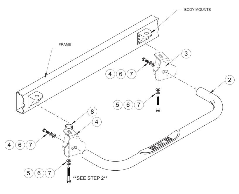
FIGURE 1 INSTALLATION VIEW OF DRIVER SIDE SHOWN, PASSENGER SIDE OPPOSITE
