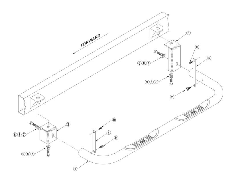
FIGURE 1 FIGURA 2 DRIVER SIDE EXTENDED CAB SHOWN
