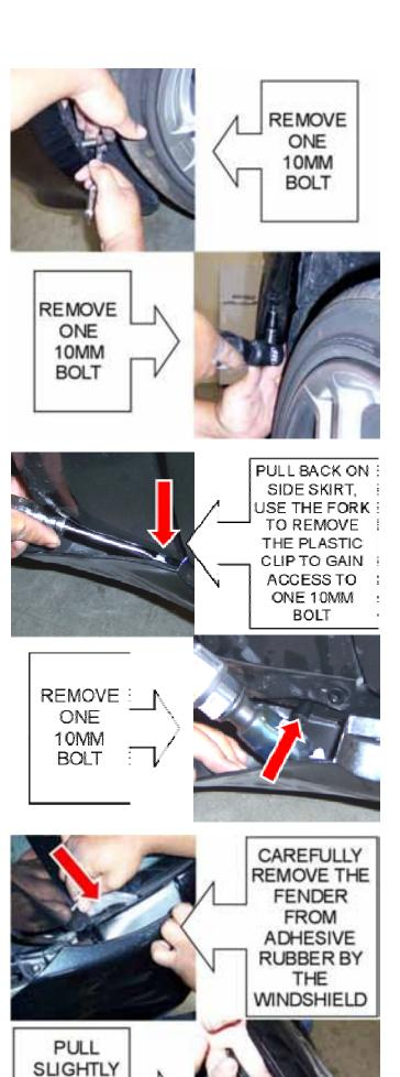
UP ON THE TAB TO RELEASE THE FENDER
