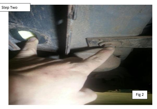
**REMOVE FACTORY SCREW LOCATED OPOSITE OF RUBBER GROMIT.**
