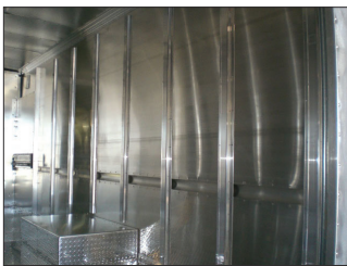
T-Stud Profile Optional 24" Spacing
