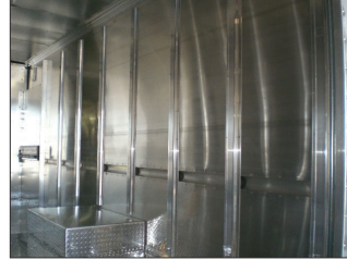
T-Stud Profile Optional 24" Spacing
