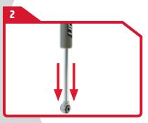
**ENSURE THE SHAFT IS EXTENDED OUT** ALL THE WAY.
