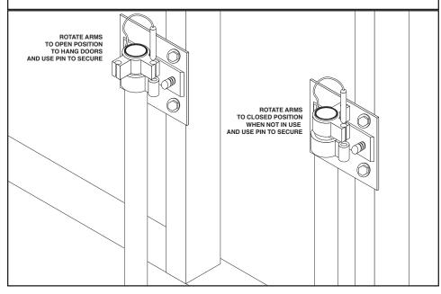
**6** OPEN POSITION ALLOWS FOR HANGING THE JEEP DOORS (WITH WIN DOWS OPEN) FROM THE DOOR WINDOW FRAME. CLOSED POSITION ALLOWS FOR BRACKET STORAGE FLUSH AGAINST WALL.
