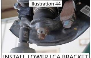
**INSTALL LOWER LCA BRACKET**
