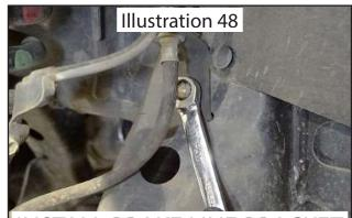
INSTALL BRAKE LINE BRACKET
