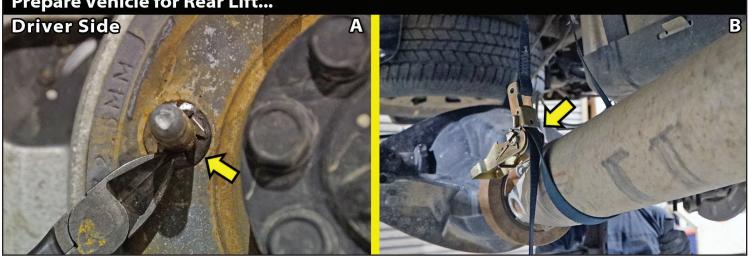
21. DISCONNECT ABS & BRAKE LINE BRACKETS FROM REAR DIFFERENTIAL...
