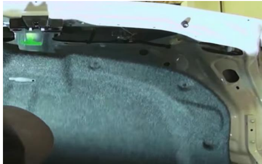
14. Remove decklid liner.
