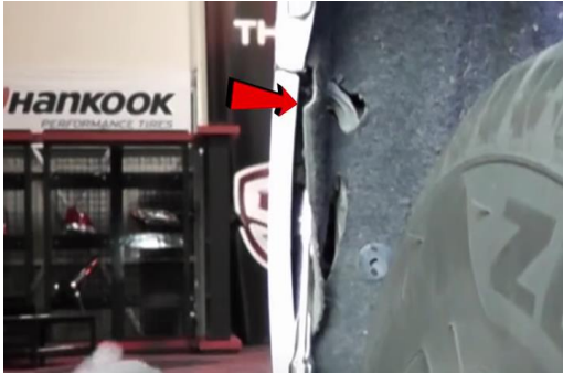
7. Remove (1x) 10mm bolt.
