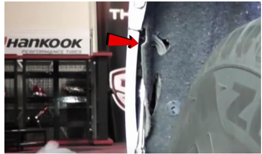
35. Reinstall (1x) 10mm bolt.
