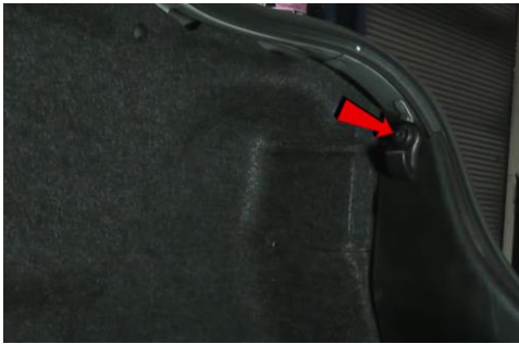
1. Remove (1x) 8mm grocery hook bolt.
