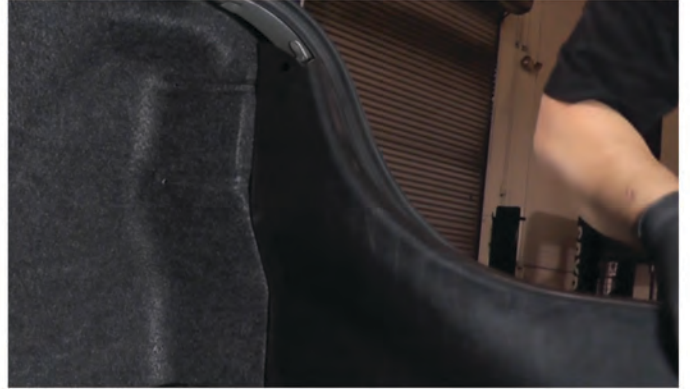
36) Reinstall trunk liner panel.
