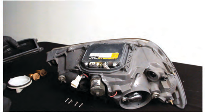
20) Remove the OEM ballast cover.
