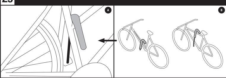
ALWAYS POSITION SMALLER BICYCLE BETWEEN THE BICYCLE SUPPORT AND THE CAR BUMPER USING THE LARGE HOOK.
