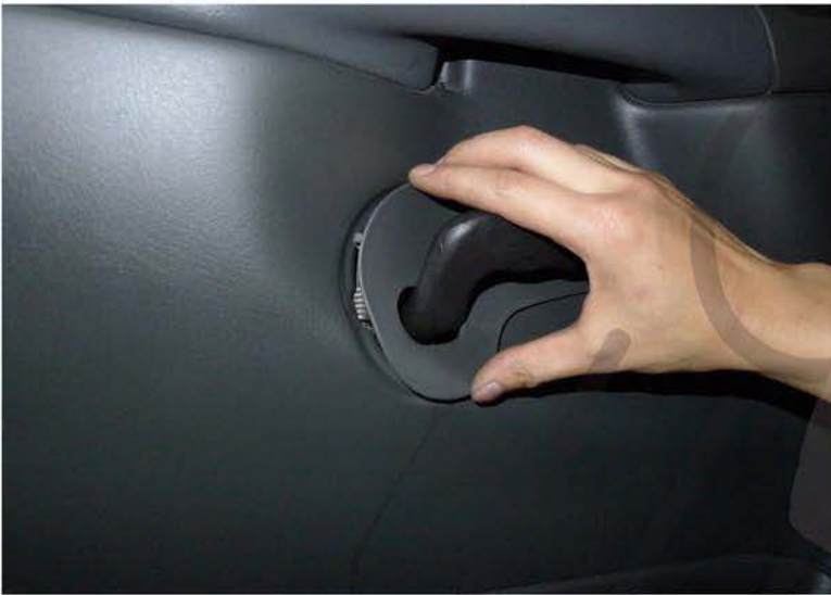
32. Replace the inside handle bezel
