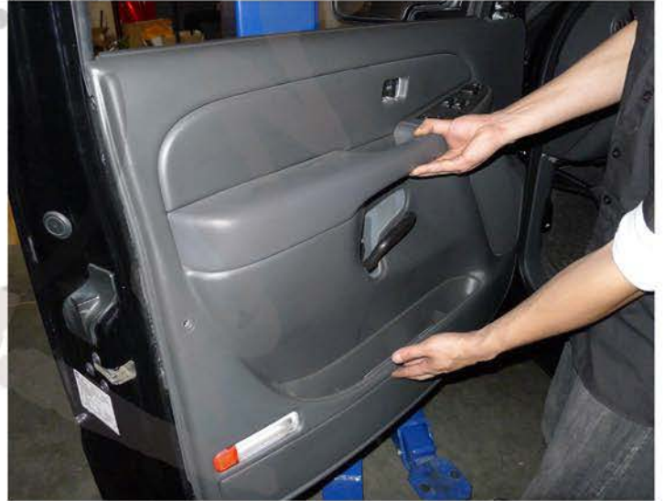
26. Replace the door panel
