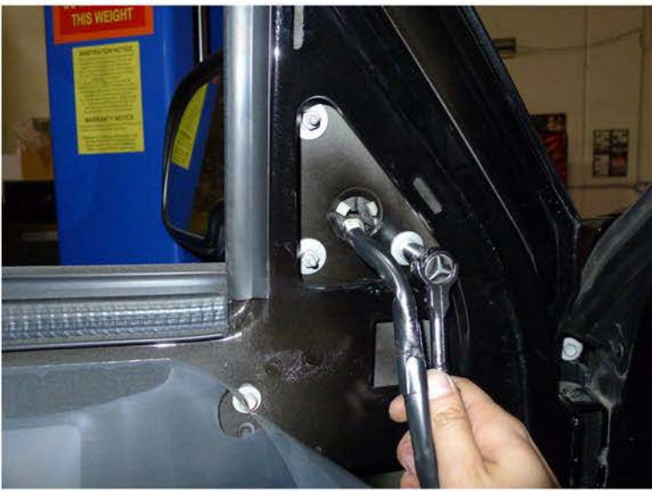
17. Remove the (3) 10mm nuts
