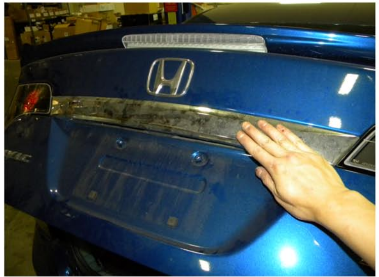
32. Replace the chrome moulding
