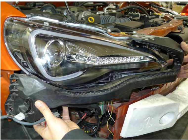
29. Replace the headlight bracket
