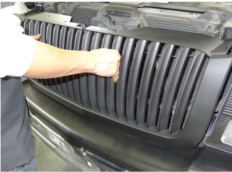
23. Install « front grill
