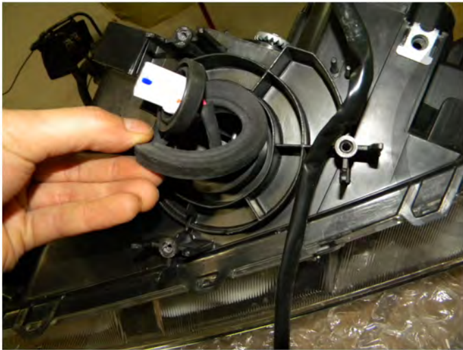
25. Remove the foam grommet
