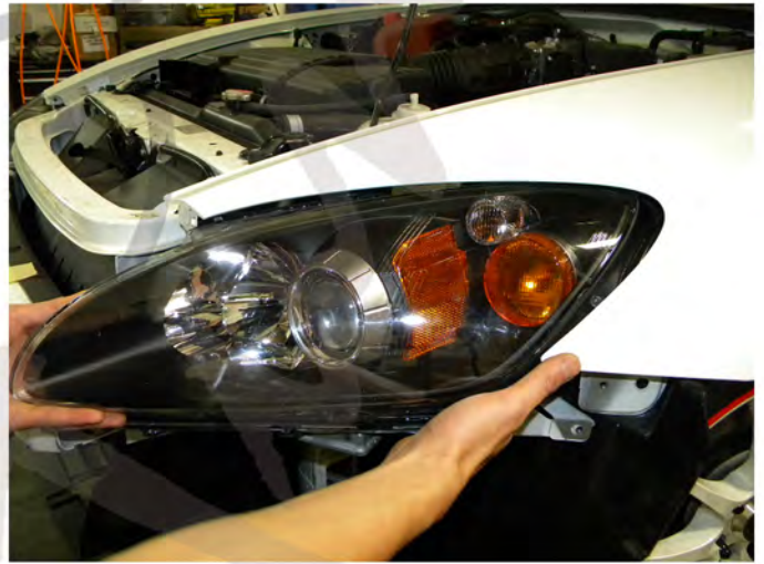
20. Remove the headlight
