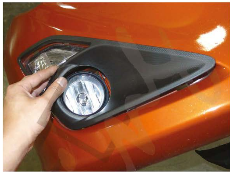
24. Install the fog light bezel
