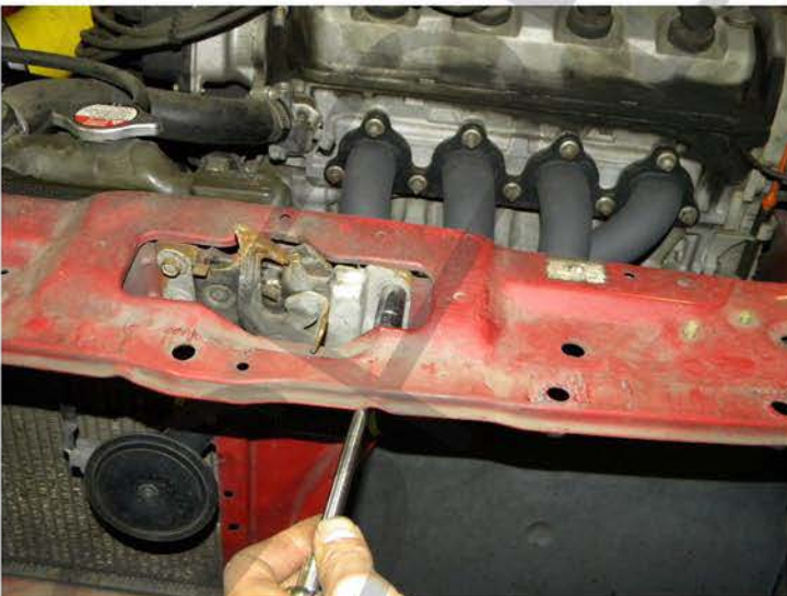
27. Remove the 10mm bolt
