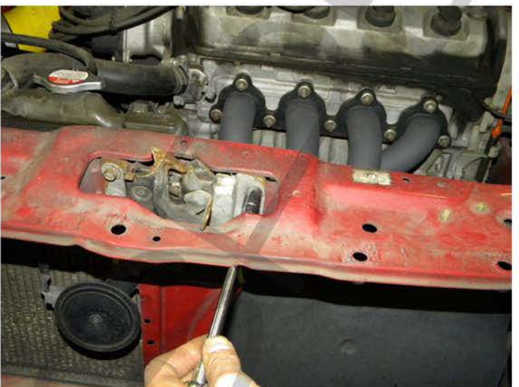
27. Remove the 10mm bolt
