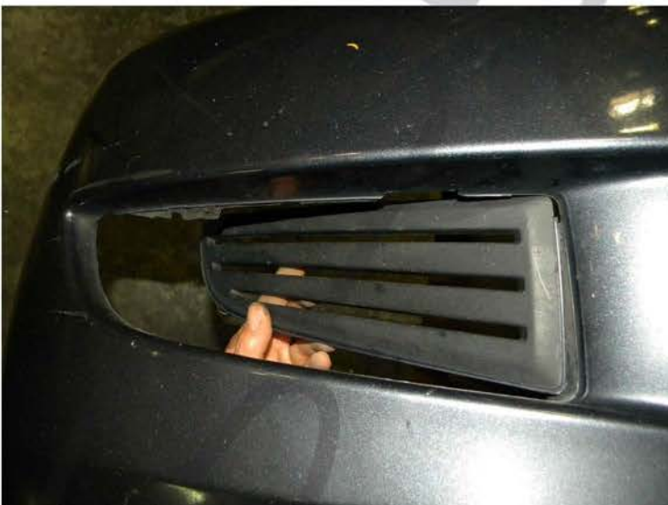
9. Remove the fog light hole cutout
