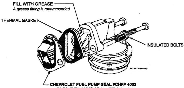
CHEVROLET FUEL PUMP SEAL #CHFP 4002 FORD FUEL PUMP SEAL #FFPG 4001 MOPAR FUEL PUMP SEAL #MOFP 4003
