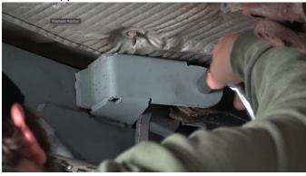
Reinstall upper sway bar end link bolt.
