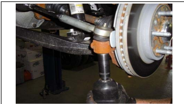
7. Remove the outer tie rod nut.
