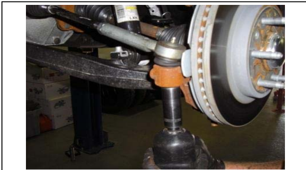
7. Remove the outer tie rod nut.
