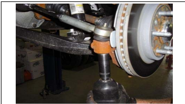
7. Remove the outer tie rod nut.
