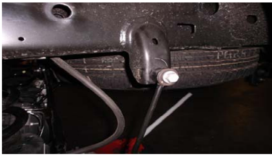
29. Reinstall the sway bar end links.
