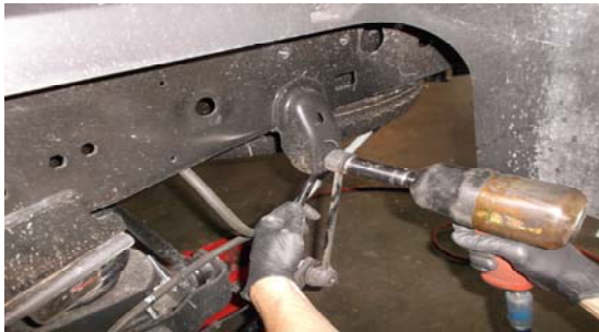
23. Unbolt the sway bar end links.
