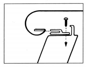
STEP TWO: LAY THE FRONT OF THE BRIEF OVER THE WINDSHIELD CHANNEL AND FOLD THE PLASTIC STRIP UNDER AND-INSERT THE FRONT EDGE OF THE BRIEF INTO THE WINDSHIELD CHANNE. PULL EACH END OF THE BRIEF UNTILL IT IS EVEN WITH THE WINDSHIELD CHANNEL.
