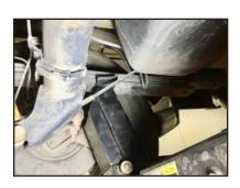
**STEP 4:** Remove lower shock bolt.
