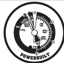
Figura: Retardo de Sincronización de Válvulas Cuando las levas están fuera de sincronización, a velocidad de ralentí el vacío oscilará entre 8 y 15 pulgadas de columna de mercurio.
