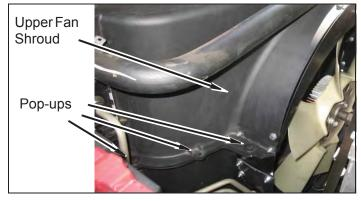
c. Remove engine fan using a fan clutch tool. .
