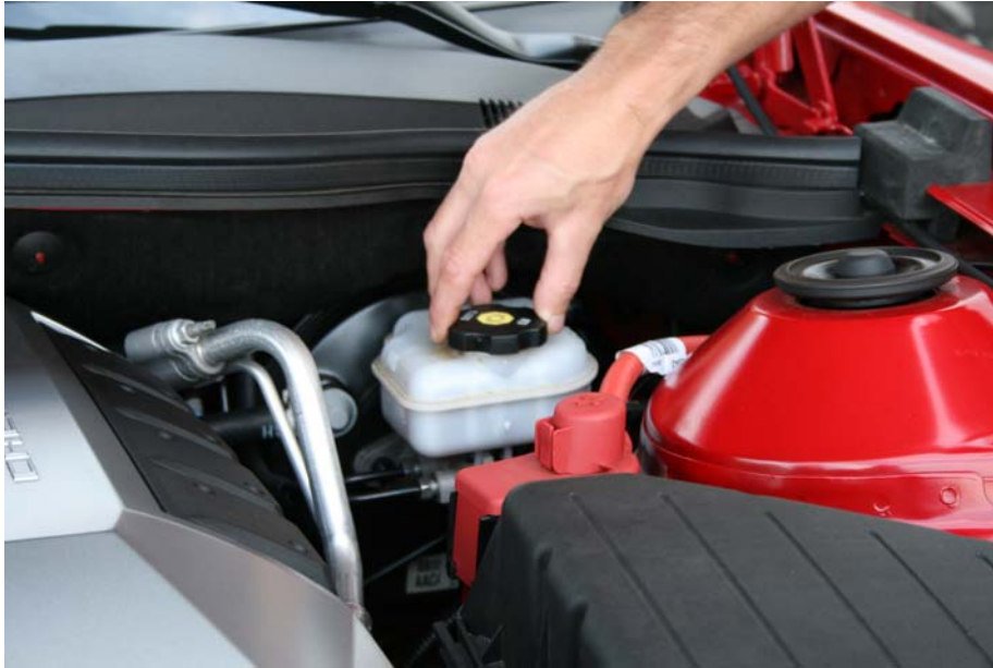
Step 1: Remove fill cap
