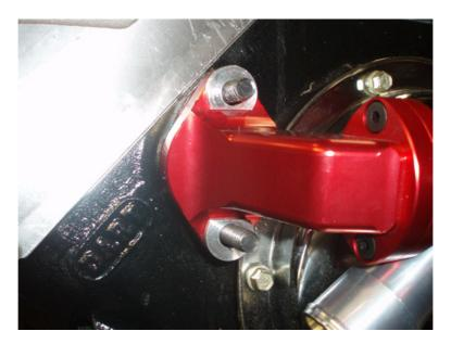
SECURE THE PUMP HAND-TIGHT WITH THE FOUR THREADED STANDOFFS. THE LONG STANDOFFS GO ON THE PASSENGER'S SIDE WHILE THE SHORT ONES GO ON THE DRIVER'S SIDE.
