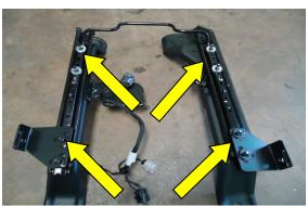
STEP 7: PLACE THE (4) SPACERS ON THE FRONT MOUNTING BOLTS, THEN THE LARGER BRACKET ON THE OUTBOARD SIDE OF THE ADJUSTER AND THE SMALLER BRACKET ON THE INBOARD SIDE.
