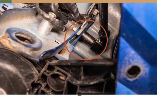
INSTALL BUMPER GUARD SUPPORT RODS.
