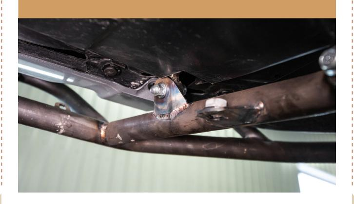
MAKE SURE BUMPER TO BUMPER GUARD GAP IS EQUAL ON BOTH SIDES
