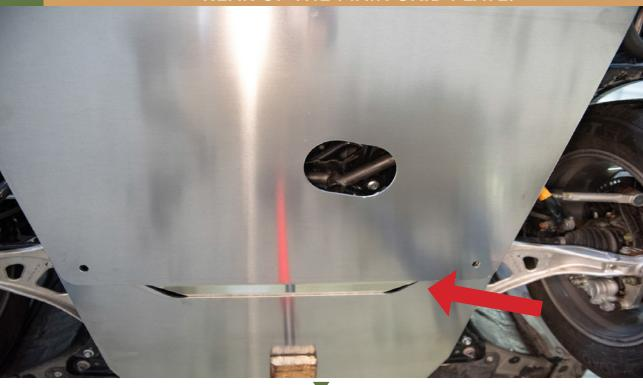
RE INSTALL THE SKID PLATE SPACERS. IF YOU DO NOT HAVE THE MAIN SKID YOU JUST NEED TO INSTALL THE SKID PLATE SPACERS
