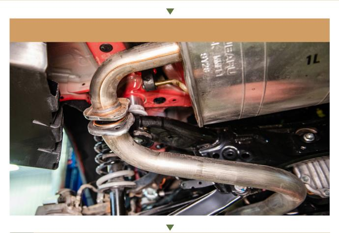
REMOVE FACTORY MUFFLER BY UN HOOKING IT FROM THE MUFFLER HANGERS
