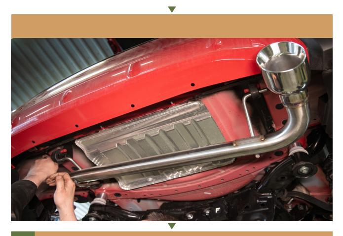
ATTACH THE MUFFLER DELETE USING THE SUPPLIED GASKET AND BOL
