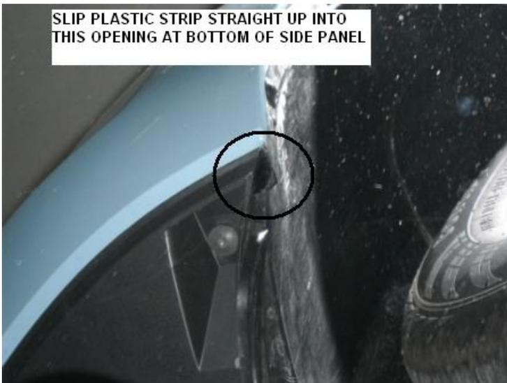
SLIP PLASTIC STRIP STRAIGHT UP INTO THIS OPENING AT BOTTOM OF SIDE PANEL
