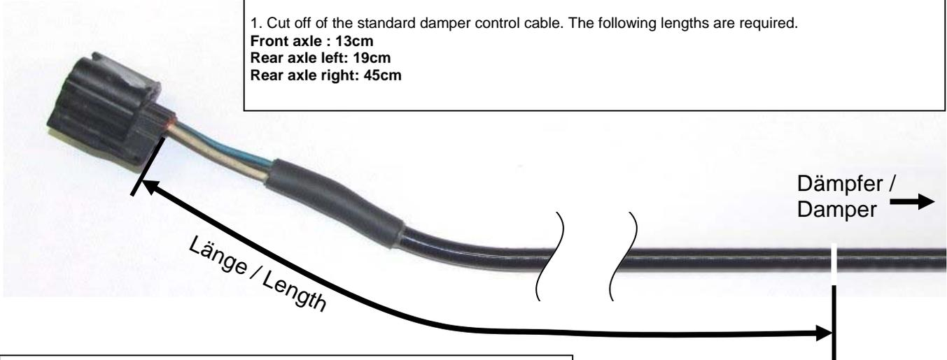
2. 15 mm von der Ummantelung der Leitung entfernen und die Adern 4 - 5 mm abisolieren. Aderdichtungen aufstecke.
