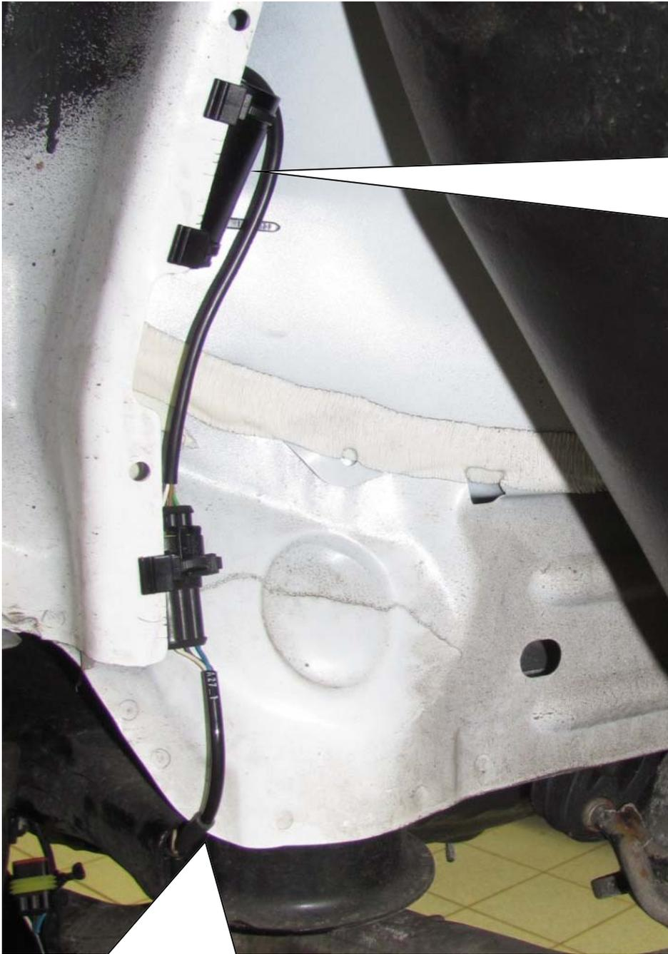
Stillegung und Adapterkabelbaum mit den mitgelieferten Edge Clips an der Karosseriekante befestigen. Adapterkabel in die Stillegung einstecken. Auf die korrekte Verriegelung des Steckers achten!
