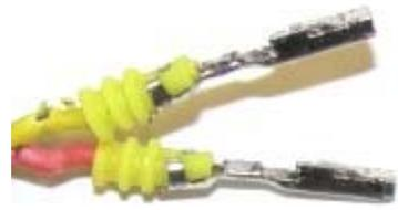
4. Steckersicherung öffnen. Fertig montierte Leitung mit Abdichtungen in das Gehäuse ganz einschieben und einrasten. Pinposition / Kabelfarbe ist nicht relevant. Anschließend Steckergehäuse verriegeln.
