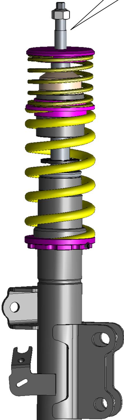
Serienmäßige Unterlegscheibe auf den Federteller aufstecken. Die Erhöhung muss zum Stützlager zeigen.
