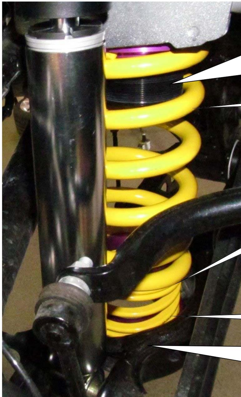
Die HA - Verstellung wird oben zwischen Feder und Karosserie montiert. Die serienmäßige Federunterlage entfällt. Zum korrigieren (verdrehen des Gewinderings) der Fahrzeughöhe ist die Verstellung aus dem Fahrzeug zu demontieren.
