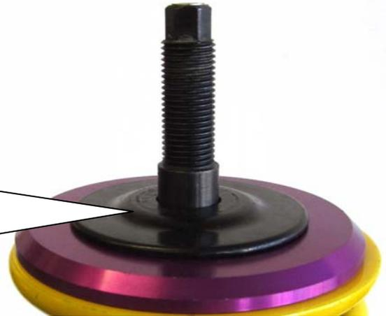
Originale Stützlagereinheit auf den Federteller aufsetzen und mit der mitgelieferten Mutter verschrauben. Das Anzugsdrehmoment der Kolbenstangenbefestigung beträgt 35 Nm. Die Montagehinweise zum Einbau des Federbeines in das Fahrzeug, sowie die Anzugsdrehmomente der Federbeinbefestigung, entnehmen Sie bitte den Unterlagen des Fahrzeugherstellers.
