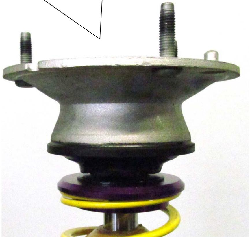
Nach erfolgtem Einbau des Fahrwerkes ist die Freigängigkeit der Bereifung zum VA-Federbein zu überprüfen. Das Mindestabstandsmaß darf an der engsten Stelle **5 mm** nicht unterschreiten und ist gegebenenfalls mittels geprüfter Distanzscheiben wieder herzustellen.
