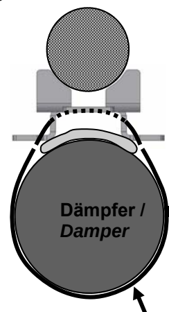
Kabelbinder / Cable ties
