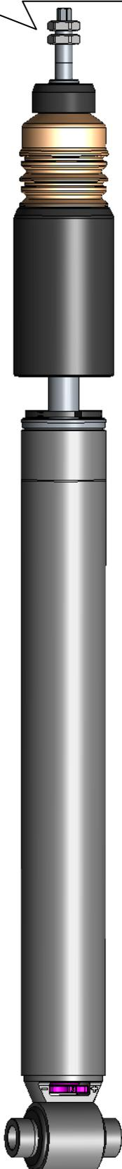
Originale Stützlagereinheit auf den Dämpfer aufsetzen und mit den mitgelieferten Muttern verschrauben. Das Anzugsdrehmoment der Kolbenstangenbefestigung beträgt 20 Nm. Die Montagehinweise zum Einbau des Dämpfers in das Fahrzeug, sowie die Anzugsdrehmomente der Befestigung, entnehmen Sie bitte den Unterlagen des Fahrzeugherstellers.
