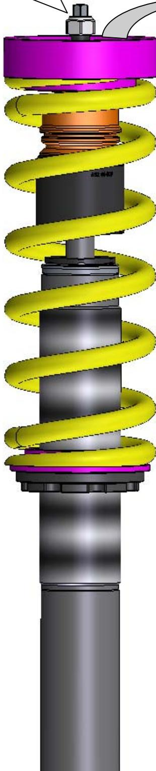
Alle Teile vom Stützlager entfernen und den mitgelieferten Federteller auf das Stützlager aufstecken. Zuvor das Stützlager gründlich reinigen!
