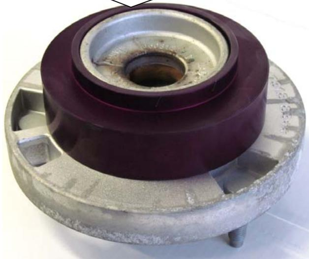
Originale Stützlagereinheit aufsetzen und mit der mitgelieferten Mutter verschrauben. Das Anzugsdrehmoment der Kolbenstangenbefestigung beträgt 40 Nm. Die Montagehinweise zum Einbau des Federbeines in das Fahrzeug, sowie die Anzugsdrehmomente der Federbeinbefestigung, entnehmen Sie bitte den Unterlagen des Fahrzeugherstellers.
