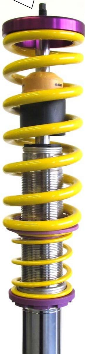
Original Stützlagereinheit ohne Gummiunterlage aufsetzen und mit den mitgelieferten Muttern verschrauben. Das Anzugsdrehmoment der Kolbenstangenbefestigung beträgt 20 Nm. Die Montagehinweise zum Einbau des Federbeines in das Fahrzeug, sowie die Anzugsdrehmomente der Federbeinbefestigung, entnehmen Sie bitte den Unterlagen des Fahrzeugherstellers.
