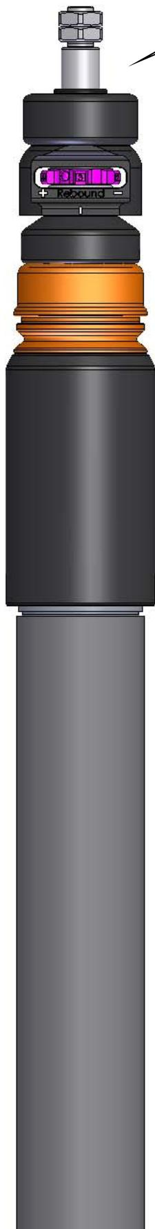
Originale Stützlagereinheit auf den Dämpfer aufsetzen und mit den mitgelieferten Muttern verschrauben. Das Anzugsdrehmoment der Kolbenstangenbefestigung beträgt 20 Nm. Die Montagehinweise zum Einbau des Federbeines in das Fahrzeug, sowie die Anzugsdrehmomente der Federbeinbefestigung, entnehmen Sie bitte den Unterlagen des Fahrzeugherstellers.
