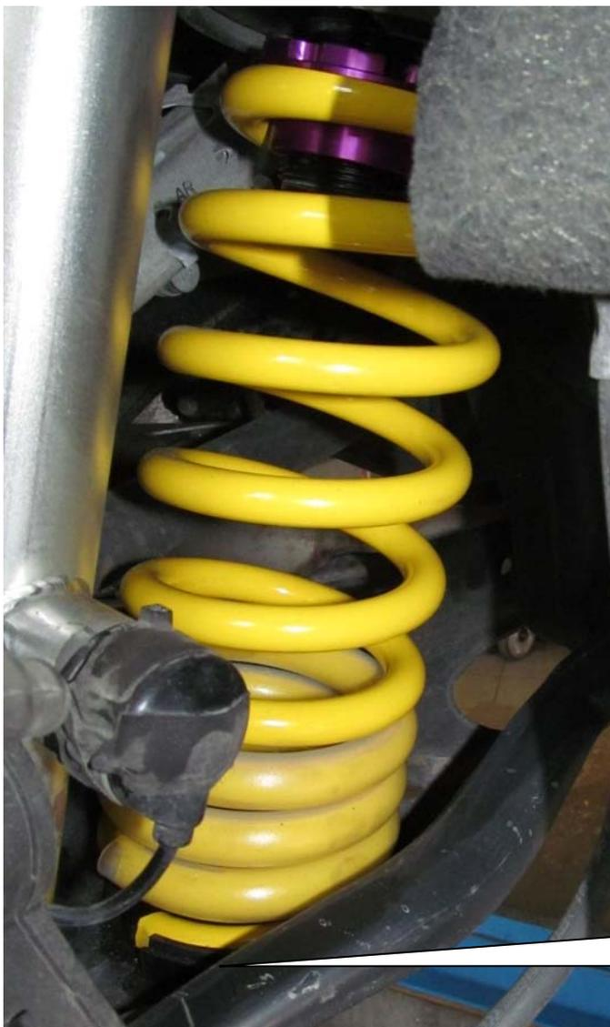
Am unteren Ende der Feder wird die originale Federunterlage weiterverwendet.
